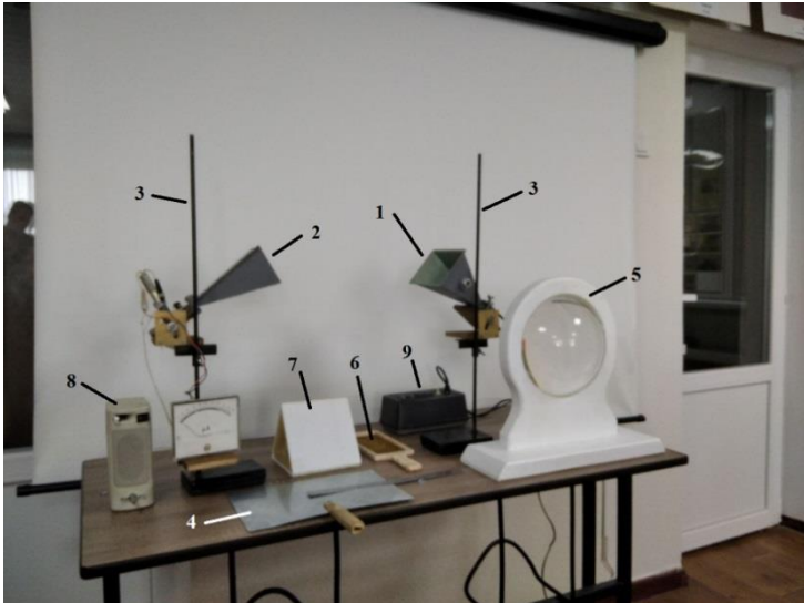
Рис. 1 – Комплект демонстрації властивостей електромагнітних хвиль
